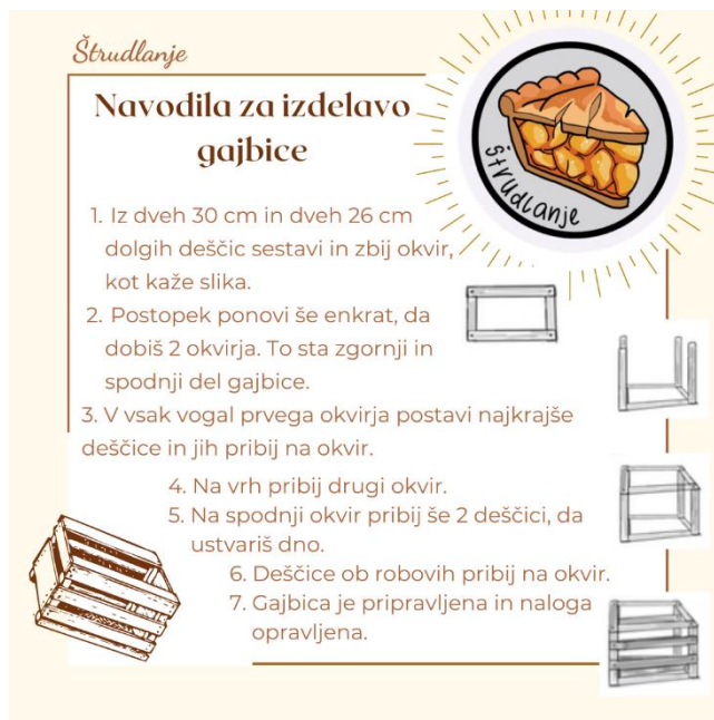
Slika 6: Navodila za izdelavo gajbice (A. Uršnik)
